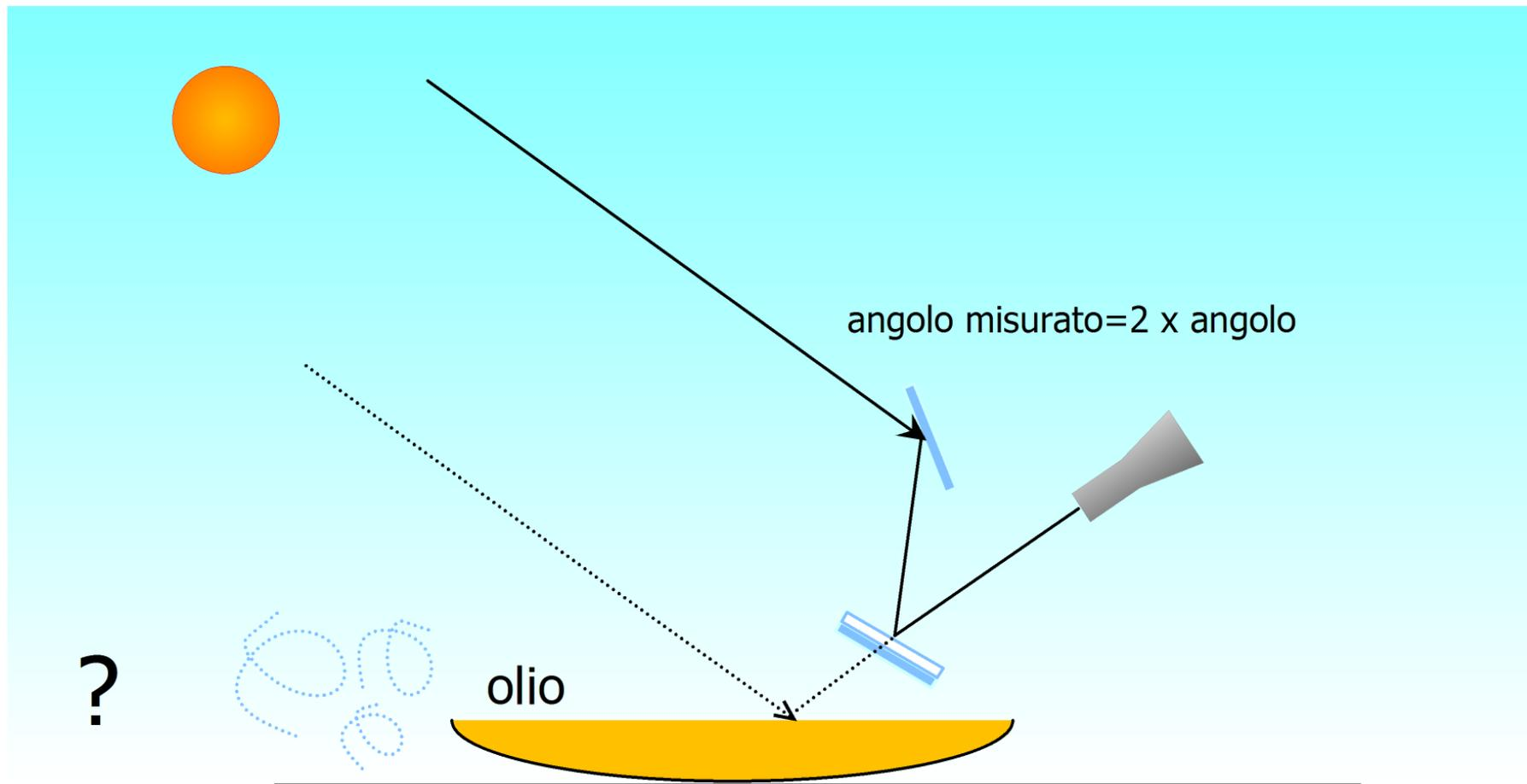
In mancanza di un orizzonte rilevabile (es. nebbia), è possibile ricorrere ad un orizzonte artificiale, riempiendo una bacinella con un liquido viscoso (per ridurre l'interferenza del vento).
